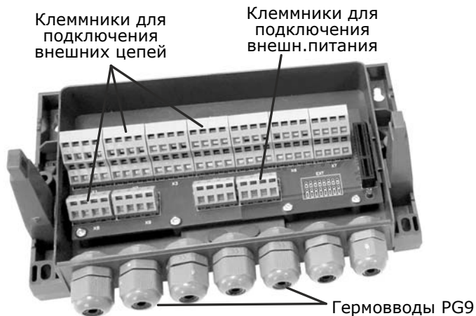
Рис. 2.4 – Вид на монтажный отсек при снятой крышке
